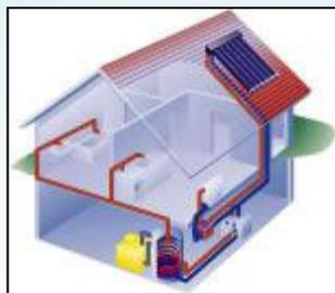
Como seja aquecer um fluido (sistemas solares térmicos), promover a sua adequada utilização num edifício (sistemas solares passivos) ou produzir energia eléctrica (sistemas fotovoltaicos).
